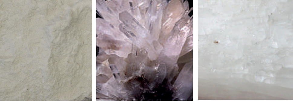
Marne, quartz et soude les éléments constitutifs et la pâte à porcelaine de Chantilly.
